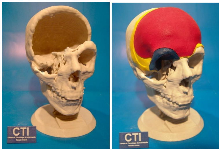
Figura 4.4.2a Biomodelo para planejamento cirúrgico e desenvolvimento de prótese personalizada utilizando a tecnologia FDM (imagens cedidas pelo CTI Renato Archer de Campinas)
